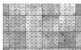
EL-Aufnahme eines intakten PV-Moduls
